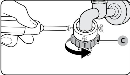
4. Setzen Sie den Adapter in den Wasserhahn ein und ziehen Sie dann die Schrauben fest, während Sie den Adapter anheben.
