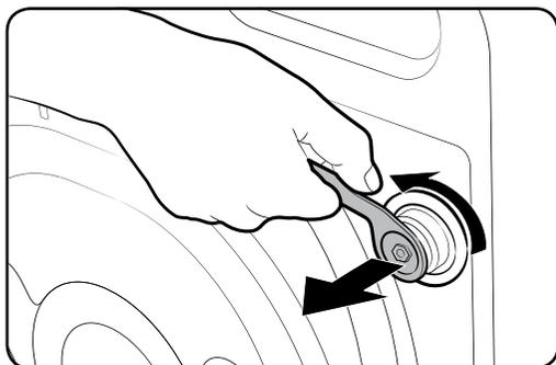
Die Produktverpackung auspacken und alle Transportsicherungen entfernen.
