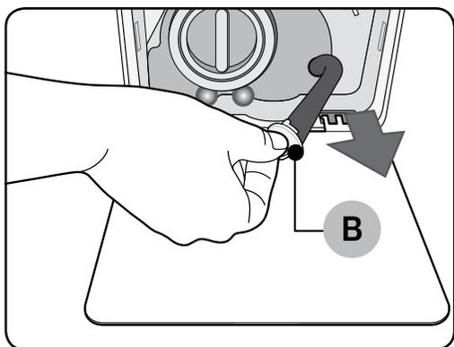
3. Legen Sie die Abdeckung in einen leeren, geräumigen Behälter und ziehen Sie den Notentleerungsschlauch zum Behälter, während Sie die **Verschlusskappe (B)** halten.
