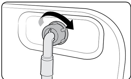
2. Verbinden Sie das andere Ende des Zuwasserschlauchs mit dem Eintrittsventil auf der Rückseite des Waschtrockners. Drehen Sie den Schlauch im Uhrzeigersinn, um ihn festzuziehen.
