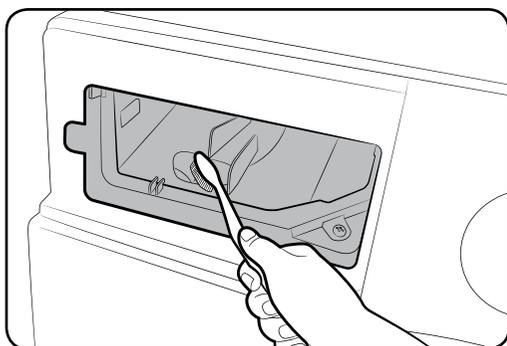
1. Während Sie den **Entriegelungshebel (A)** auf der Innenseite des Waschmittelbehälter herunterdrücken, schieben Sie den Waschmittelbehälter auf.
