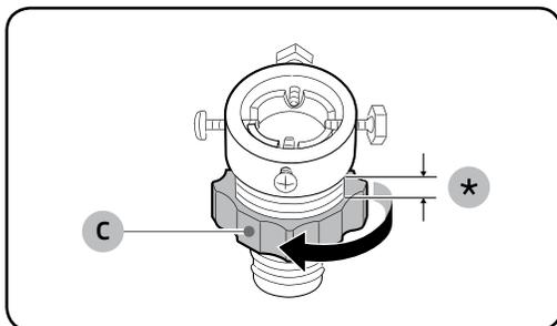
3. Halten Sie den Adapter fest und drehen Sie Teil (C) in Pfeilrichtung, um es um 5 mm zu lösen (\*).
