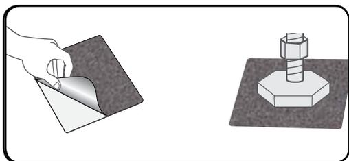
1. Reinigen Sie vollständig den unteren Teil der verstellbaren Füße und entfernen Sie den Staub und das Öl.
