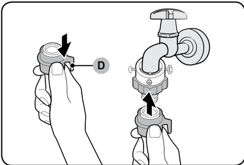
6. Während Sie **Teil (D)** am Wasserschlauch ziehen, schließen Sie den Wasserschlauch an den Adapter an. Lassen Sie dann **Teil (D)** los. Der Schlauch rastet mit einem Klickgeräusch im Adapter ein.
