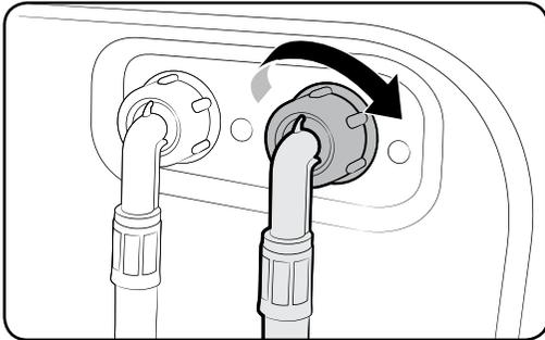
1. Verbinden Sie das rote Ende des Warmwasserschlauchs mit dem Warmwasseranschluss auf der Rückseite des Wäschetrockners.
