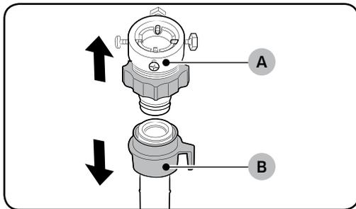
1. Entfernen Sie den Adapter (A) vom Zuwasserschlauch (B).
